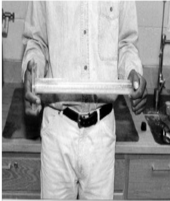
Hình 4 – Phương pháp dùng tay lắc ống thí nghiệm.
